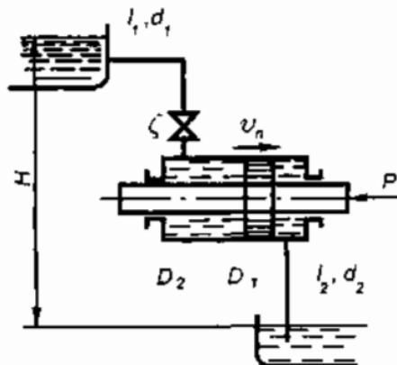
**Задача 9.47.** В установке поршневого гидродвигателя расположенный напор воды  $H = 40 \text{ м}$ . Вода подводится к полости высокого давления цилиндра по трубе размерами  $l_1 = 60 \text{ м}$ ,  $d_1 = 150 \text{ мм}$  и отводится от полости низкого давления по трубе размерами  $l_2 = 10 \text{ м}$ ,  $d_2 = 150 \text{ мм}$ . Шероховатость обеих труб  $\Delta = 0,5 \text{ мм}$ .
