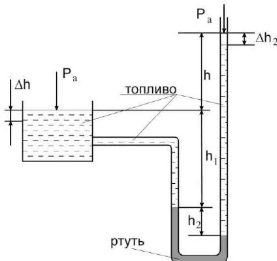
**Задача 3.** Для передачи наверх и контроля уровня топлива в открытом подземном резервуаре использован дифференциальный манометр, заполненный ртутью, плотность которой  $\rho_{\text{рт}} = 13,6 \text{ т}/\text{м}^3$ . Определить высоту столба ртути  $h_2$ , если разность уровней топлива в указателе и резервуаре  $h$  м. Как изменится положение уровня в указателе при понижении уровня топлива в резервуаре на  $\Delta h$  м?
