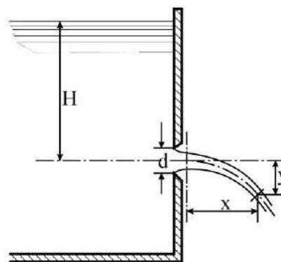
**Задача 17.** Определить коэффициенты расхода, скорости и сопротивления при истечении воды в атмосферу через отверстие диаметром  $d$  под напором  $H$ , если расход  $Q$ , а координаты центра одного из сечений струи  $x = 3 \text{ м}$  и  $y = 1,2 \text{ м}$ .
