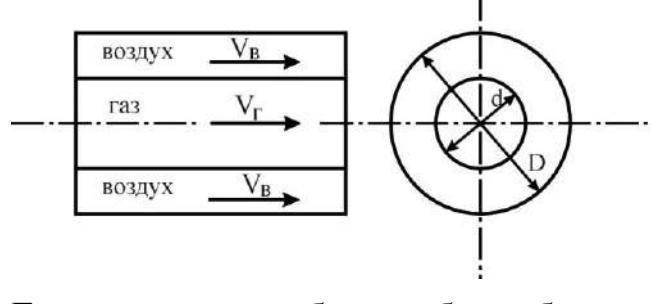
**Задача 13.** Горелка типа «труба в трубе» работает на газе и потребляет  $m_g$  кг/час газа. Воздух необходимый для горения газа в количестве  $1,6 m_g$  кг/кг газа имеет температуру  $t_b$   $^{\circ}\text{C}$  и подводится через кольцевое пространство горелки со скоростью  $V_b$  м/сек.
