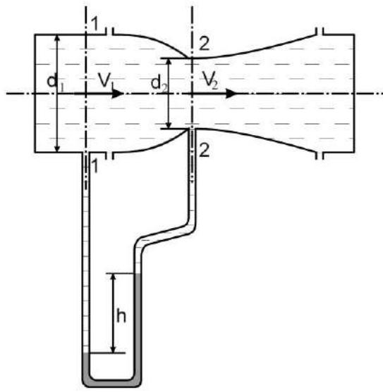
**Задача 6.** Для измерения расхода бензина, плотность которого  $\rho_b = 0,73 \text{ т}/\text{м}^3$ , на трубопроводе диаметром  $d_1$  установлен расходомер Вентури. Диаметр суженной части расходомера  $d_2$ . Определить, пренебрегая сопротивлениями, расход бензина  $Q \text{ м}^3/\text{с}$ , если разность уровней в дифференциальном манометре, присоединенном к расходомеру, равна  $h$ .
