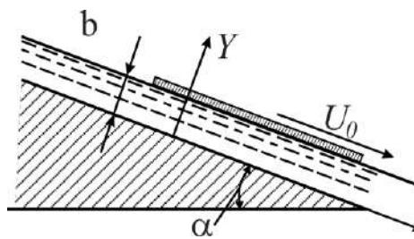
**Задача 19.** По слою жидкости, находящемуся на наклонной плоскости, перемещается параллельно последней пластина с постоянной скоростью  $u_0$ .
