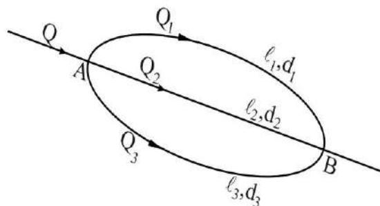
**Задача 11.** На стальном трубопроводе с общим расходом  $Q$  л/с имеется участок с тремя параллельно включенными ветвями  $\ell_1, d_1$ ;  $\ell_2, d_2$ ;  $\ell_3, d_3$ . Определить распределение расхода по отдельным ветвям и потери напора между узловыми точками  $H_{AB}$ .
