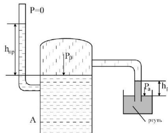
*Задача 2.* Определить абсолютное давление воздуха  $P_0$  на поверхности воды в резервуаре А и высоту поднятия воды в закрытом пьезометре  $h_{\text{пр}}$ , присоединенном к этому резервуару, если показание ртутного вакуумметра  $h_{\text{пр}}$ , а атмосферное давление  $P_a$ .
