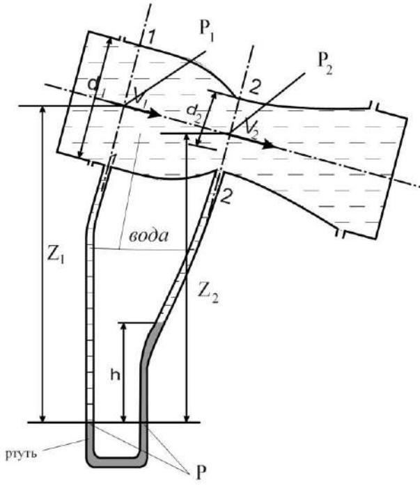
*Задача 2.* Определить расход воды, проходящей через расходомер Вентури, если разность уровней, показываемая дифференциальным ртутным манометром,  $h = 600 \text{ мм}$ . Большой и меньший диаметры водомерной трубы соответственно равны  $d_1 = 200 \text{ мм}$ ,  $d_2 = 75 \text{ мм}$ .
