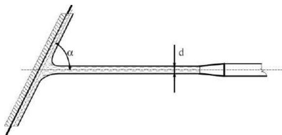
**Задача 15.** Пожарный брандспойт представляет собой суживающуюся насадку с диаметром выходного сечения  $d$ , имеющую коэффициент сопротивления  $\zeta = 0,1$  и коэффициент сжатия  $\varepsilon = 0,85$ . Определить расход воды и силу, с которой струя, выходящая из брандспойта, бьет в стену, расположенную под углом  $\alpha$  к направлению струи, если давление воды, подводимой к брандспойту  $\Delta P$  атм.
