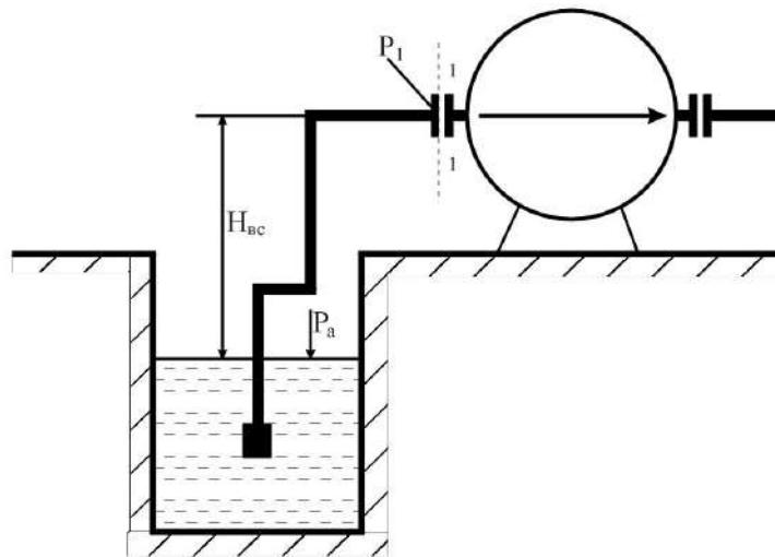
**Задача 9.** Центробежный насос забирает воду из колодца в количестве  $Q$  л/с. Всасывающая труба насоса длиной  $\ell$  и диаметром  $d$  снабжена предохранительной сеткой и обратным клапаном ( $\zeta_{кл} = 10$ ) и имеет три поворота ( $\zeta_{пов} = 0,29$ ). Определить допустимую высоту всасывания насоса  $H_{вс}^{доп} = ?$ , при которой вакуум во всасывающем патрубке насоса не превышал бы допустимого значения  $h_{вак}^{доп} = P_{вак}^{доп}/\rho g$ .
