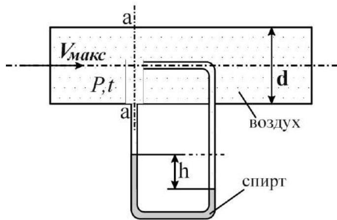
**Задача 7.** Напорная трубка (трубка Пито) установлена на оси газопровода диаметром  $d$ , по которому перетекает воздух. Его плотность при нормальных физических условиях ( $t_0=0^{\circ}\text{C}$ ,  $P_0=760$  мм рт. ст. и  $\varphi=50\%$ )  $\rho_0=1,293$  кг/м<sup>3</sup>, а динамический коэффициент вязкости (при  $t_0=0^{\circ}\text{C}$ )  $\mu=17,3 \cdot 10^{-6}$  Н·с/м<sup>2</sup>.
