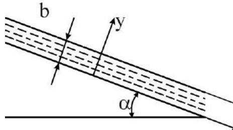
**Задача 18.** Слой жидкости ( $b = 3 \text{ мм}$ ,  $v = 1,5 \cdot 10^{-4} \text{ м}^2/\text{сек}$ ) равномерно движется под действием силы тяжести по наклонной плоскости, составляющей с горизонтом угол  $\alpha$ .
