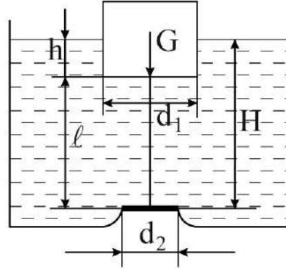
**Задача 4.** На дне резервуара с бензином имеется круглый клапан диаметром  $d_2$ , который прикреплен тягой к цилиндрическому поплавку диаметром  $d_1$ . При превышении какого уровня бензина  $H$  откроется клапан, если вес поплавка и клапана  $G$ , длина тяги  $\ell$ , а плотность бензина  $\rho_b = 0,73 \text{ т}/\text{м}^3$ .
