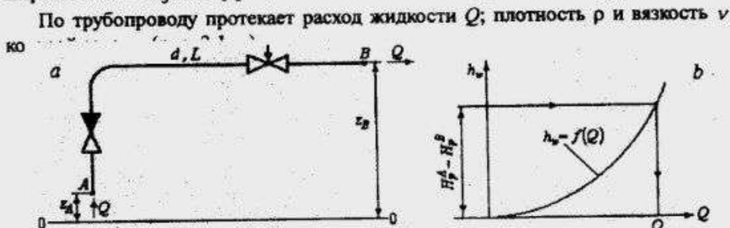
Рис.3.1. К расчету простого трубопровода постоянного сечения
