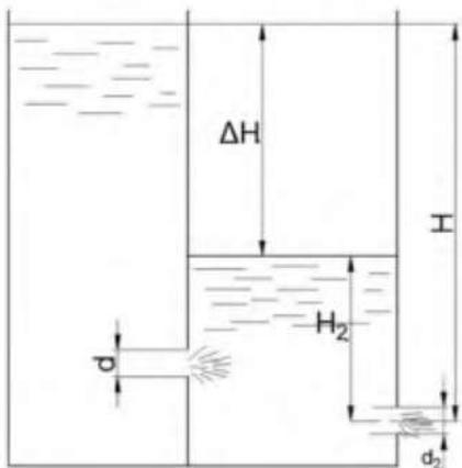
Бак, применяемый для измерения расхода воды, вытекающей в атмосферу через круглое отверстие в тонкой стенке диаметром  $d_2 = 200$  мм, снабжен для успокоения воды вертикальной перегородкой с двумя круглыми отверстиями равного диаметра  $d = 100$  мм (рис. 35). Полный напор над центром тяжести наружного отверстия  $H = 2$  м поддерживается постоянным. Определить расход воды  $Q$ ,  $H_2$  и перепад уровней  $\Delta H$ .
